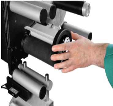
Eine Silikon-Unterlage der Etiketten klebt auf 180 Grad an den Gummi-Förderrollen. Ein zweites gerändelt-selbst-ausrichtender-Controller garantiert eine gleiche Förderung auf die ganze Länge.
